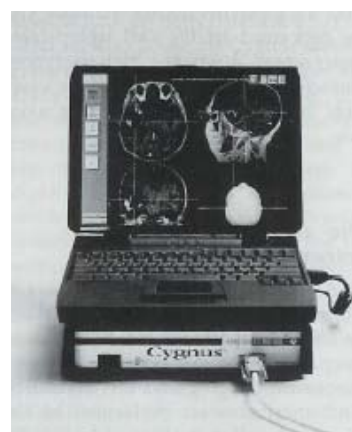
图 2. 用于在外科手术前进行规划和外科手术中进行导航的便携式计算机, 显示在 Cygnus 电磁控制单元之上。
